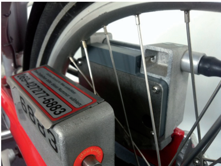
Schloß und HW-Einheit am Hinterrad des Call a Bike-Mietfahrrads.
